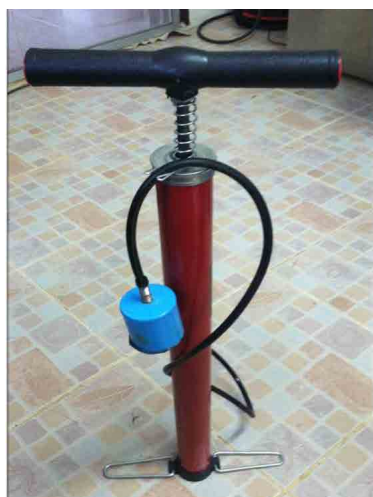
Figure 6. Pompe à vélo modifiée pour une aspiration sous vide. Source: le Personnel de ECHO en Asie
