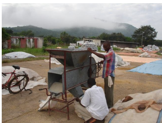
图 5.来自加纳的简单的手动种子/谷物清理机。它手动操作的，很难降低速度来防止谷物被吹飞。
