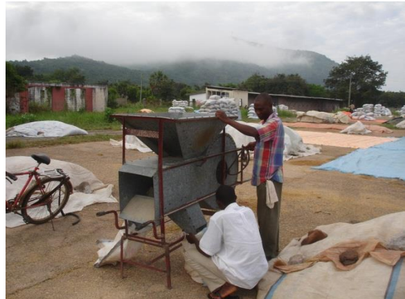
Hình 5: Thiết bị làm sạch hạt giống/ngũ cốc hoạt động bằng tay từ Ghana. Chúng thường được vận hành bằng tay; có thể khó khăn vì phải đẩy người xuống đủ mạnh giúp ngăn ngũ cốc không bị thổi bay đi.
