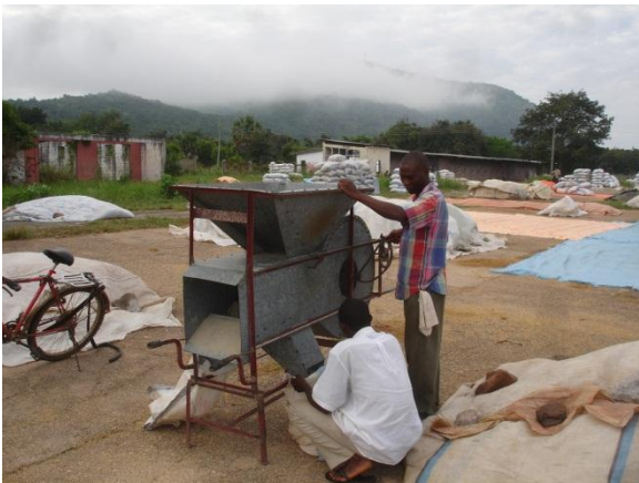
ပုံ ၅။ ဂါနာနိုင်ငံမှ သာမန်လက်လုပ် အစေ့/အန်သန့်စင်သောစက်။ ၎င်းတို့သည်အများအားဖြင့် လက်ထိုးလုပ်ရသော အရာများဖြစ်၍ အစေ့များလွင့်စင်မှုမှကာကွယ်ရန်အင်အားကြီးသောဂီယာအမျိုးအစား များကိုလုံလောက်စွာထိန်းချုပ်ရန်ခက်ခဲနိုင် သည်။
