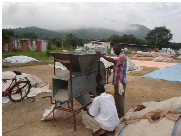
រូបភាពទី៥៖ ការសំអាតគ្រាប់ពូជដោយម៉ាស៊ីនដៃនៅប្រទេសហ្គាណា។ ដែលប្រើដោយដៃ វាអាចមានការលំបាកបន្តិចនៅក្នុងប៉ុន្តែវាការពារការខ្ចាតចេញនៃគ្រាប់ពូជ
