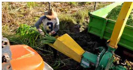
Alimentación de pasto de elefante a la desmenuzadora. Fuente: Dexter B. Dombro
