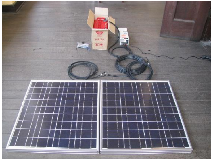
រូបភាព ៨: ឧបករណ៍ទាញយកថាមពលអគ្គិសនីពីព្រះអាទិត្យ ដើម្បីប្រើប្រាស់ នៅក្នុងទម្រង់បណ្តុះគ្រាប់ សំរាប់តំបន់ ដែលគ្មានអគ្គិសនីទៅដល់។
