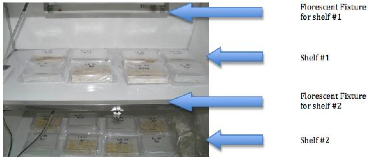
រូបភាព ៣: ធ្វើរ ២ បិទជិតត្រូវបានប្រើសំរាប់បណ្តុះគ្រាប់ និងកូនប្រអប់ជ័រដាក់នៅ ខាងក្នុងទូរ។ អំពូរ និងកូនជ្រូកត្រូវបានគេចង់ព្យួរនៅខាងលើរបស់ធ្វើរនិមួយៗ។ ខ្សែ ភ្លើងត្រូវបានគេសកតាមប្រហោង ដែលបានចោះ ហើយទំលាក់មកថតខាងក្រោម ដែលជាកន្លែងដាក់ខ្សែភ្លើង និងប្រដាប់កំណត់ម៉ោង។
