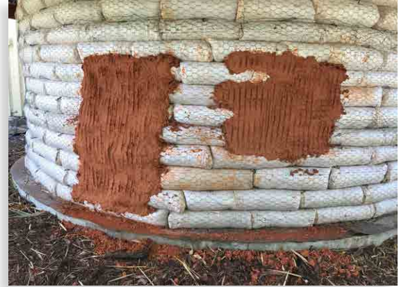
Figura 14. Comparando mezclas de repello en el banco de semillas del campus de ECHO en Florida.
