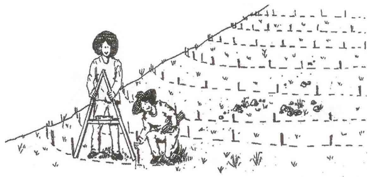
Figura 2: Marcando una curva de nivel.
