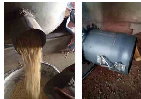
Figura 11. Tubo de descarga del grano y tapa para sellar salida. Fuente: Edward Martin
