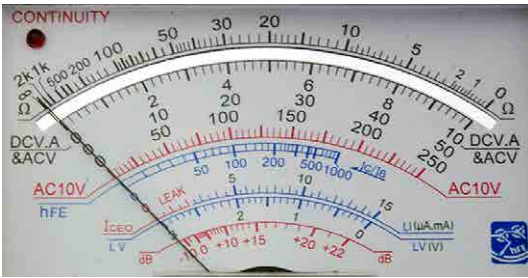
Figura 12: Escala de medidor de un multímetro ohm/volt. La escala de ohmios ( \Omega ) está en la parte superior. Fuente: Tim Motis
