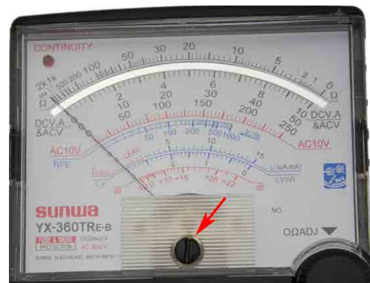
Figura 8: Aguja colocada sobre infinito con el medidor sin usar o apagado. El ajustador de cero, tal como lo muestra la flecha, puede girarse para ajustar la posición de la aguja. Fuente: Tim Motis
