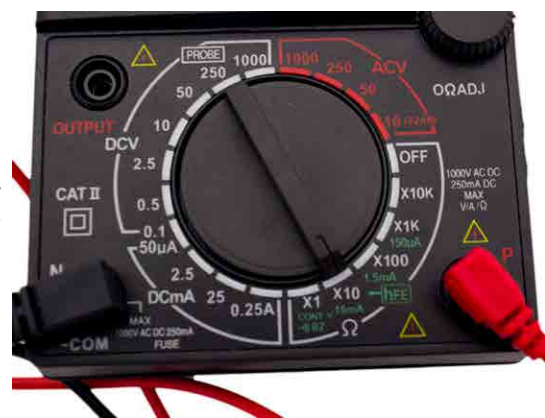
Figura 9: Los cables conectados al medidor fijado en X10 ohmios. Fuente: Tim Motis
