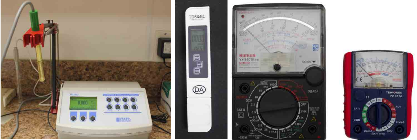
Figura 7: Instrumentos para medir la salinidad. Aquí se muestran medidores de conductividad eléctrica de laboratorio (izquierda) y manuales (centro), así como también multímetros ohm/volt (derecha). Fuente: Tim Motis
