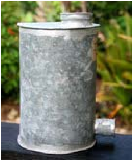
Figure 1 : Silo à grains métallique miniature. Les grains sont versés dans le silo par l'ouverture sur le dessus (laquelle est normalement scellée). Les grains sont retirés par le bec dans le bas du silo.
