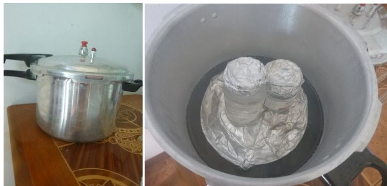
图 7. 厨房压力锅用于给琼脂和其他器皿消毒。把一个三脚架放在压力锅里并放 2 到 3 厘米的水（水不会触到罐底）。把锡箔纸包着的罐子放在锅中间，压力锅的盖子离罐子至少 2 厘米。
