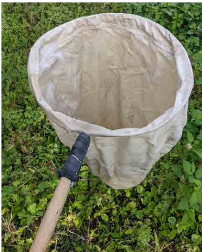
Figura 5. Una red entomológica fabricada con una funda de almohada, alambre grueso, bambú y un amarre de goma. Fuente: Annie Deutsch
