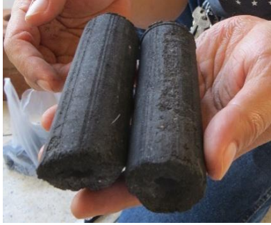
Gambar 6. Briket ramah lingkungan yang terbuat dari sekam padi di Pertanian Aloha House, Filipina. (Kredit Foto: Abram Bicksler).
