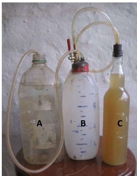
图 4：酵母在容器 C 中产生二氧化碳。在容器 B 中收集并替代容器 A 中的水。然后进行二氧化碳洗刷，将容器 C 换成装满种子的储存容器并在容器 A 中加入水，水会把二氧化碳挤压到容器 C 中。
