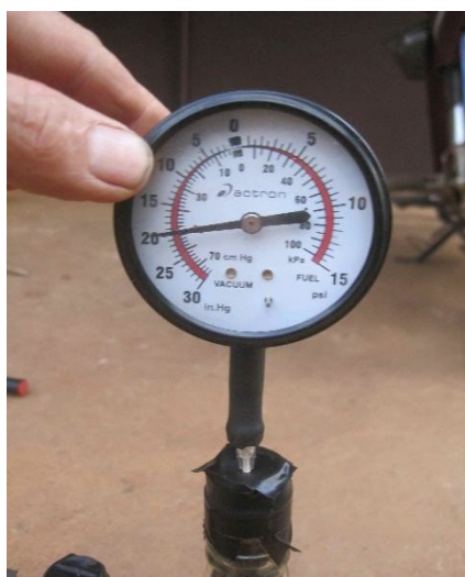
图 3：用压力测试器检查真空密封容器的相对压力。
