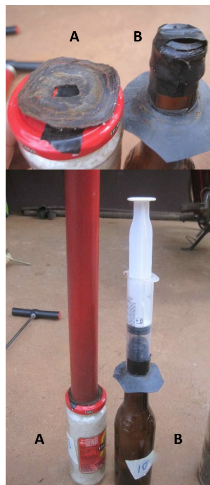
Figure 2: 用于高效真空泵的橡胶密封圈 A)是大开口 B) 是小开口容器
