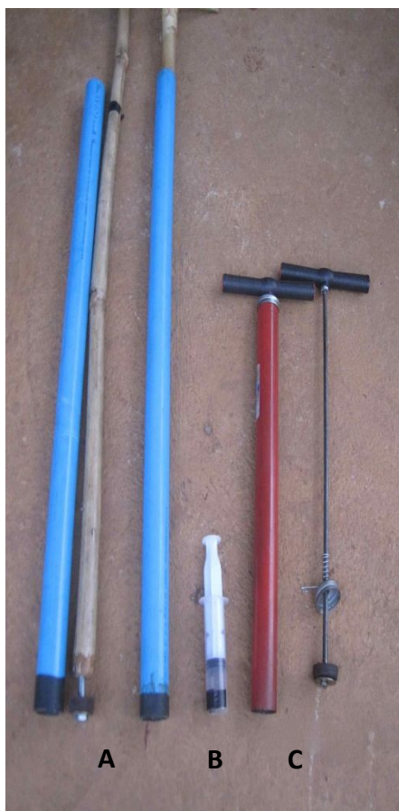
图 1: 用柬埔寨农村可获得的材料制成的三个低成本真空泵 A) 真空泵使用 PVC 和竹子; B) 注射器真空泵; C) 反转的自行车真空泵。
