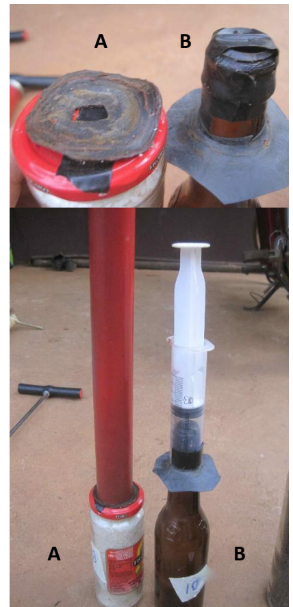
ภาพที่ 2: แผนผังของสุบลมสุญญากาศสำหรับ A) ภาชนะที่มีฝาขนาดใหญ่ B) ภาชนะที่มีฝานขนาดเล็ก
