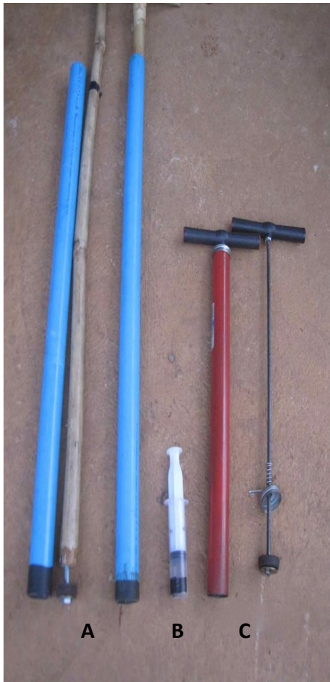
ภาพที่ 1: อุปกรณ์ดูดอากาศราคาประหยัด 3 อย่างที่ใช้วัสดุที่ทำได้ทั่วไปในเขตชนบทของประเทศกัมพูชา: A) สูบลมสุญญากาศใช้ท่อพีวีซีและไม้ไผ่; B) สูบลมสุญญากาศไซริงค์หรือกระบอกฉีดยา; และ C) สูบลมสุญญากาศดัดแปลงจากที่สูบลมล้อจักรยาน
