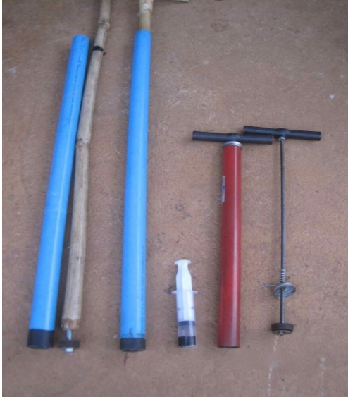
ပုံ ၁။ ကမ္ဘောဒီးယား ကျေးလက်ဒေသတွင်ရနိုင်သည့် ပွည့်ဖြင့်ပြုလုပ်သည့်ဈေးသက်သာသောစုတ်ထုတ်ရန်အသုံးပြုသည့်ပန်းသုံးခု၊ က) ပီစီစီပိုက်နှင့်ဝါးကိုအသုံးပြုသည့်လေစုပ်ပန်း၊ ခ) ဆေးထိုးအပ်လေစုပ်ပန်း၊ ဂ) ပြောင်ပြန်ပြုလုပ်ထားသည့်စက်ဘီးလေစုပ်ပန်း
