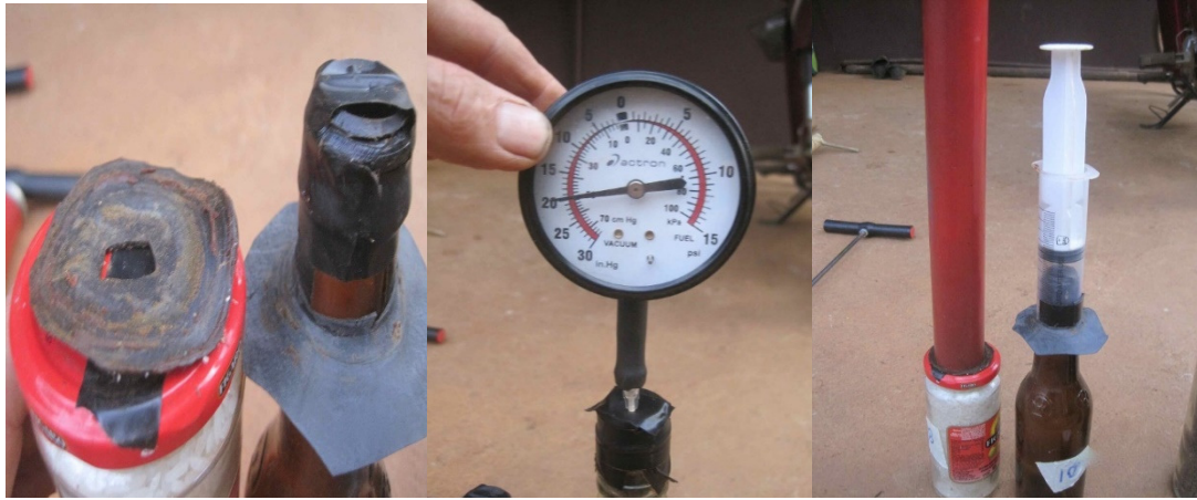
ပုံ ၂။ ထိရောက်မှုရှိသည့်လေစုပ်ပန်းအတွက် သားရေအပိတ်။ က)အကြီး၊ ခ) အငယ်၊ ဂ) ငယ်သော- ထိပ်ပိုင်းထည့်ရန်ပစ္စည်း။ ပုံ ၃။ လေစုပ်ထုတ်ပြီးချိတ်ပိတ်ထားသည့်ထည့် စရာပစ္စည်း၏လေဖိအားကိုတိုင်းသောကရိယာ
