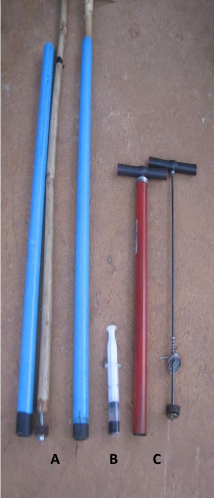
រូបទី 1: ស្នប់បូមខ្យល់ចេញចំនួន៣ដែលមានតំលៃថោក ដែលធ្វើពីសំភារៈដែលរកបាននៅក្នុងតំបន់ក្នុងតំបន់ដាច់ស្រយាលក្នុងប្រទេសកម្ពុជា A) ស្នប់ប្រើបំពង់ទឹកជ័រនិងឬស្សី B) ស្នប់ប្រើស៊ីរ៉ាំងបូម និង C) ស្នប់ប្រើពីស្នប់សំបកកង់ម៉ូតូ។
