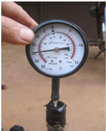
រូបទី៣: ប្រដាប់វាស់សំពាធខ្យល់កំពុងពិនិត្យសំពាធនៃការបូមខ្យល់ចេញ.
