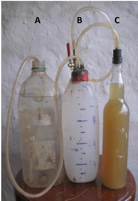
រូបទី៤: ការបូមឌីអុកស៊ីតដែលបង្កើតឡើងពី ដំបែនៅក្នុងភាជន៍ទុកដាក់ C។ វាត្រូវបានចាប់យកដោយភាជន៍B ហើយយកទឹកចេញទៅក្នុងភាជន៍ A. សំរាប់ ការលាងដោយការបូមឌីអុកស៊ីត. ភាជន៍ C គឺត្រូវបានជំនួសដោយភាជន៍ទុកដាក់គ្រាប់ពូជដែលមានគ្រាប់ពូជពេញហើយទឹកត្រូវបានបន្ថែមទៅក្នុងវាបានផ្សំរុញទឹកទៅក្នុងភាជន៍Bដើម្បីរុញការបូម
