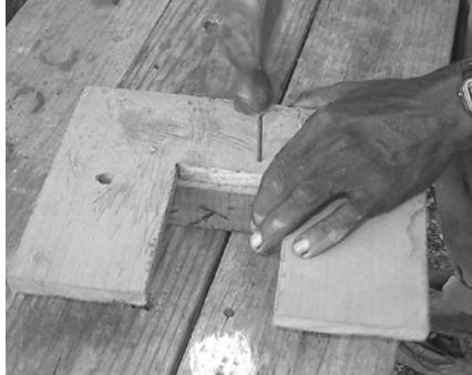
Koure yon ti moso bwa sou planch la raz ak twou pou tiyo a. Fòk planch la pi long pase tiyo gen diamèt.
