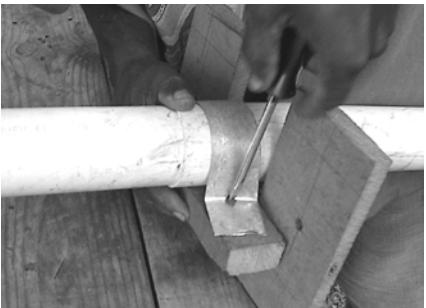
Fikse ponp lan sou planch la ak 2 vis ak band tòl la. Fòk li kenbe l di.
