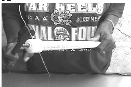
Fè vis boulon an pase sou twou a. Apre sa mete kap la sou tiyo a. Fikse kap la ak yon fil a ligati. Chofe fil la e fè l pase sou PVC yo.
