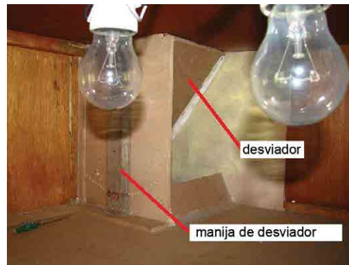
Figura 7. Gabinete de secador de semillas (izquierda) y conjunto del desviador (derecha) modificado para usarse donde es necesario sacar humedad del gabinete.
