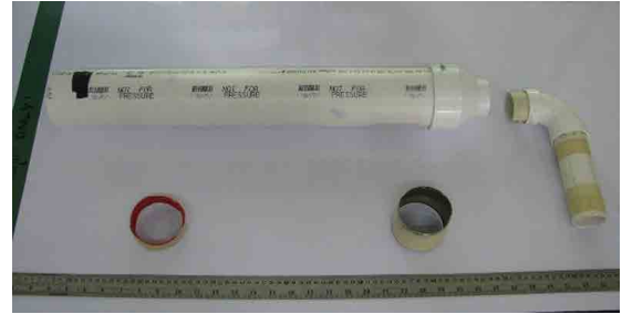
Figura 8. Método de secar semillas dentro de una columna de PVC utilizando un soplador de aire (izquierda). Se muestran rejillas (abajo) que sostienen las semillas dentro de la columna de PVC.
