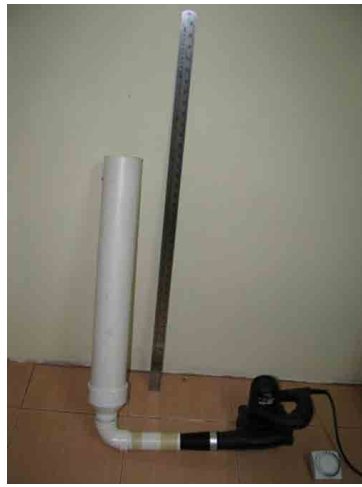
Figura 8. Método de secar semillas dentro de una columna de PVC utilizando un soplador de aire (izquierda). Se muestran rejillas (abajo) que sostienen las semillas dentro de la columna de PVC.
