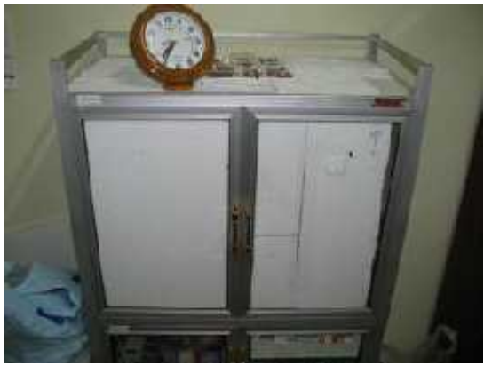
រូបទី ១: ទូរណ្តុះគ្រាប់ (សូមមើលសេចក្តីពិស្តារស្តីពី ការសង់នៅក្នុងអត្ថបទ EAN ខែមករា ឆ្នាំ២០១១
