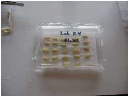
រូបទី៧ : ចិទកែវ petri ដោយច្រកសេរីងឱ្យល្អ ដែលមានសរសេរឈ្មោះពីលើ ហើយច្រកគែមខាងក្រោមឱ្យល្អ (ដើម្បីទប់សំណើម ប៉ុន្តែមិនឱ្យខ្យល់ចូលជាដាច់ខាត)។
