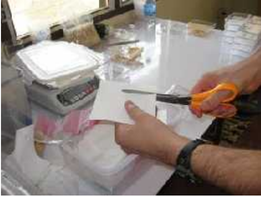
រូបទី ៣ : ការកាត់ក្រដាសអនាម័យដាក់ចូលក្នុង កែវ petri : កាត់ក្រដាស អនាម័យដែលបត់ពីរដោយប្រើកន្ត្រៃបន្តាប់មក តម្រឹមតែមបណ្តោយក្រដាសអនាម័យឱ្យត្រូវនឹងកែវ petri ។
