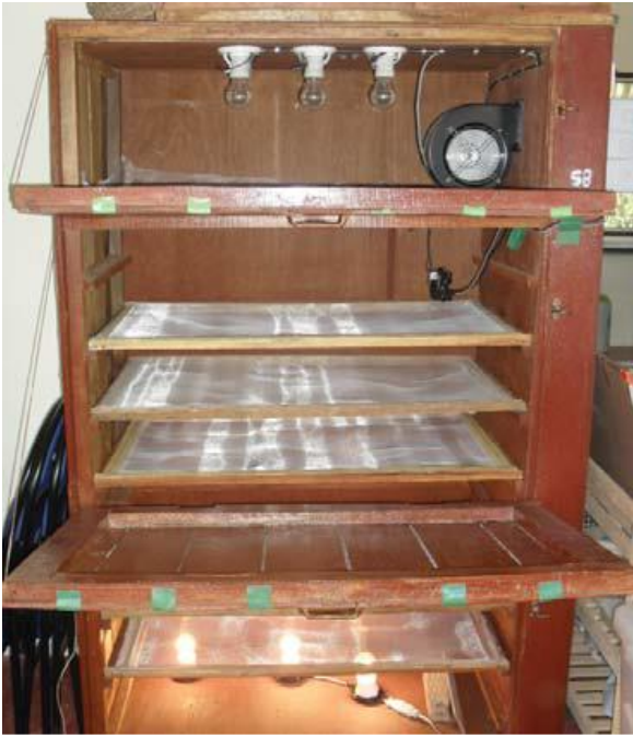
រូបទី៦៖ ម៉ាស៊ីនសម្ងាត់គ្រាប់ពូជអេកូអាស៊ីលេខ ១ បង្ហាញផ្ទៃដែលបានបង្កើត អំពូលផ្តល់ពន្លឺភ្លឺក្តៅ និងកង្ហារកំប្រុកសម្រាប់ឱ្យខ្យល់ចេញចូលមុន បន្ថែមនូវ។ កង្ហារផ្តល់ខ្យល់ក្តៅពីលើចុះក្រោមតាមរយៈជញ្ជាំងដើម្បីជួយឱ្យខ្យល់ក្តៅធ្វើចលនាចុះឡើង។
