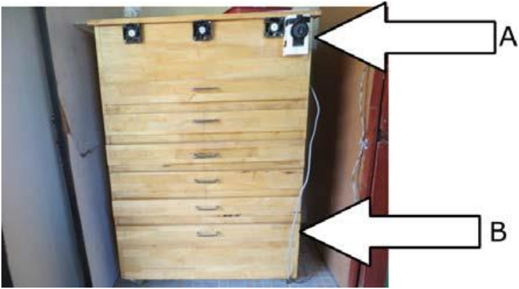
រូបទី៨៖ ម៉ាស៊ីនសម្ងួតគ្រាប់ពូជអេកូអាស៊ីលេខ ២ ដែលធ្វើបិទជិតទាំងអស់។ A) ទែម៉ូស្តាត និងកង្ហារបក់ឱ្យមានខ្យល់ចេញចូល។ B) ធ្វើសម្ងួត
