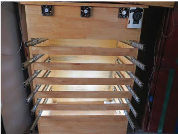
រូបទី១០៖ បង្ហាញពីផ្នែករឹងសម្រាប់ធ្វើដែលអាចបំលាស់ទីបាននៃម៉ាស៊ីនសម្ងួតគ្រាប់ពូជលេខ ២
