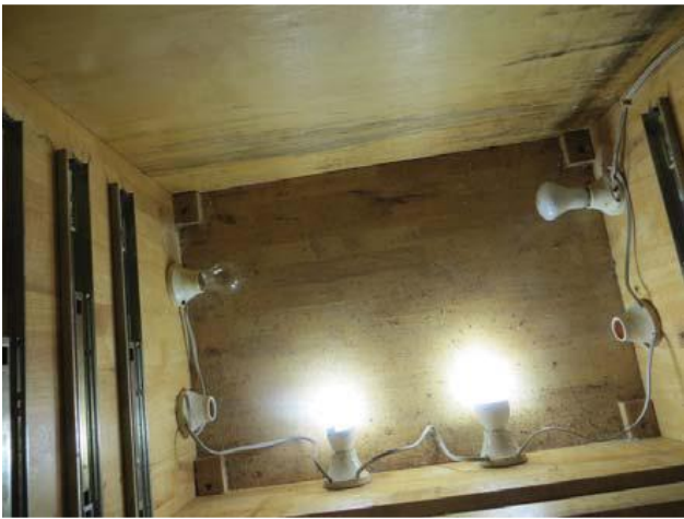
រូបទី៩៖ ក្រឡេកមើលម៉ាស៊ីនសម្ងួតគ្រាប់ពូជលេខ ២ នៅកន្លែងប្រកបកំដៅ។ មិនមែនអំពូលទាំងអស់សុទ្ធតែចាំបាច់សម្រាប់បង្កើតកំដៅដែលចង់បាននោះទេ។
