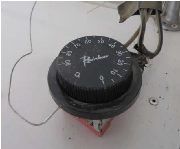
រូបទី១៤៖ ទែម៉ូស្តាតដើម្បីត្រួតពិនិត្យសីតុណ្ហភាពកំដៅនៅខាងក្នុងម៉ាស៊ីនសម្អាតគ្រាប់ពូជលេខ ៣
