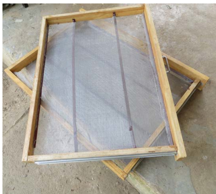
Gambar 12: rak-rak dari jarak dekat, menggunakan materi kasa pada Pengering benih #2
