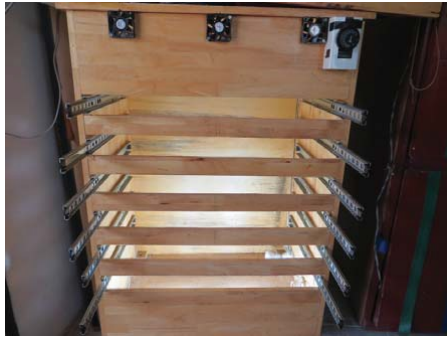
Gambar 10: Menunjukkan perangkat keras dari rak-rak yang bisa dipindah pada Pengering Benih #2
