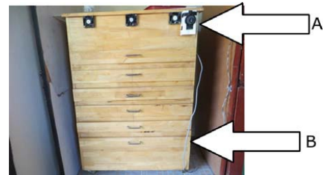
Gambar 8: Pengering Benih ECHO Asia #2 dengan semua rak dalam kondisi ditutup. A. Termostat dan kipas ventilasi. B. Rak-rak pengering.
