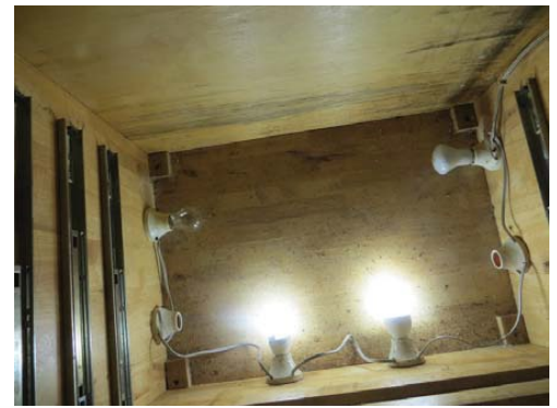
Gambar 9: Memandang ke bawah ke dalam Pengering Benih #2. Tidak semua lampu pijar dibutuhkan untuk menciptakan panas yang diinginkan.
