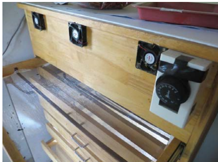
Gambar 11: Dari dekat—termostat, kipas angin dan rak-rak yang dipindah pada Pengering Benih #2
