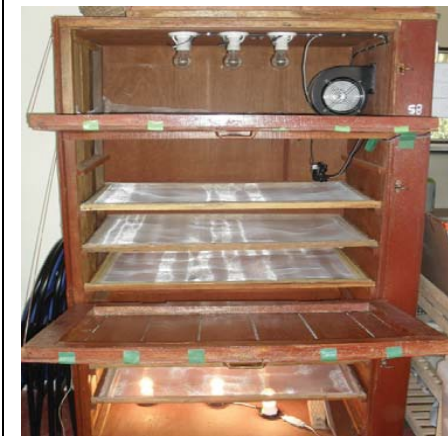
Gambar 6: Pengering Benih ECHO Asia #1 menunjukkan rak buatan sendiri, bolam lampu, kipas untuk mengalirkan udara sebelum ada tambahan ventilasi. Kipas ini meniup udara yang sudah panas dari atas ke bawah untuk mensirkulasi-ulang udara panas.
