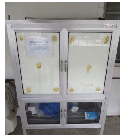
Gambar 13: Pengering Benih Modular #3 dengan desain asli berdasarkan Ruang Perkecambahan Benih ECHO Asia.
