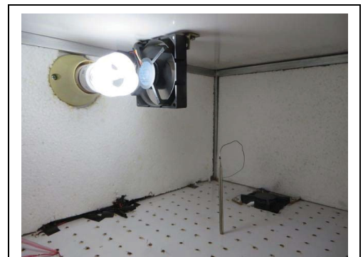
Gambar 16: Dari dekat—lampu pijar, kipas, dan termostat pada Pengering Benih #3
