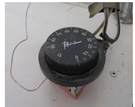
Gambar 14: Termostat untuk mengatur suhu pemanasan di Pengering Benih #3
