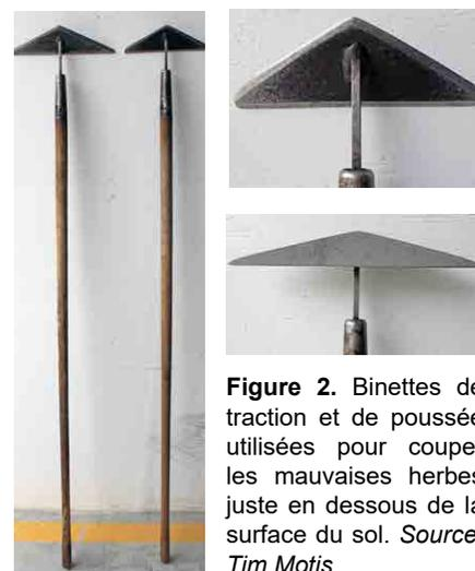
**Figure 2.** Binettes de traction et de poussée utilisées pour couper les mauvaises herbes juste en dessous de la surface du sol. Source: Tim Motis
