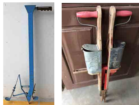
Figura 12. Plantador de empujones del estilo utilizado en la finca demostrativa de ECHO en Florida (izquierda) y un plantador de empujones utilizado en el Este de África (derecha). Fuente: Tim Motis (izquierda) y Stacy Reader (derecha)
