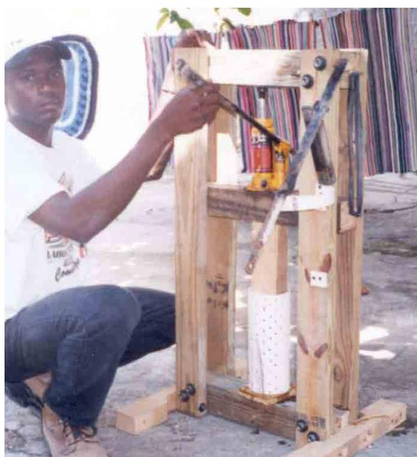
**Figure 13:** Bottle jack briquette press
