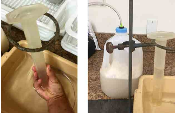
Figure 8. Méthode de déplacement de l'eau pour mesurer le débit d'un gaz. Source: Tim Motis
