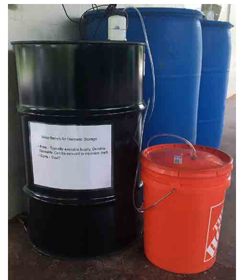
Figure 7. Dioxyde de carbone d'un seau s'écoulant dans un fût métallique récipient des graines de maïs. Des trous pour les tubes et l'évacuation de l'air ont été percés dans un couvercle modifié, fait de pièces de plomberie en PVC, pour éviter de percer le fût. Source: Tim Motis
