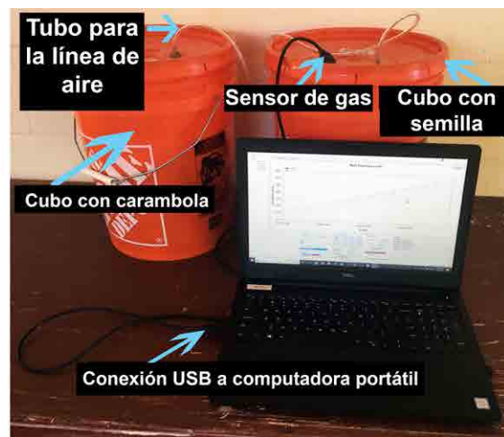
Figure 4. Seau de caramboles (à gauche) relié à un seau de graines (à droite), avec un capteur pour mesurer le CO 2 dans le seau de graines. Source: Tim Motis
