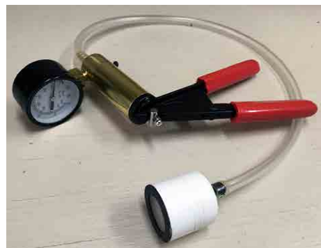
Figure 2. Pompe à purge de frein à vide modifiée comme expliqué dans la Note Technique n°93 de ECHO. Source: Tim Motis
