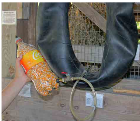
Figure 3. Récipient de graines modifié avec des tiges pneumatiques en bas et en haut du récipient de graines. La chambre à air était connectée à la tige pneumatique inférieure, dont le noyau de valve a été retiré pour permettre au gaz de s'écouler dans le récipient. Le noyau de valve a été retenu dans la tige pneumatique en haut de la bouteille afin qu'on puisse presser la tige du noyau de valve (pour permettre à l'air de s'échapper pendant que le récipient est rempli de biogaz) puis la relâcher (pour retenir le biogaz dans le récipient une fois plein). Source: Tim Motis
