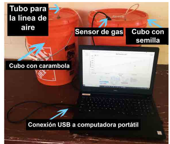
Figura 4. Cubo con carambola (izquierda) conectado a un cubo con semillas (derecha), con un sensor para medir el CO 2 en el cubo de semillas. Fuente: Tim Motis
