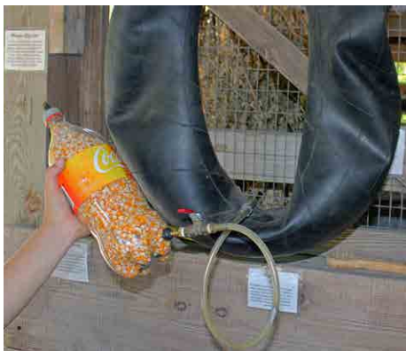
Figura 3. Contenedor de semillas modificado con válvulas de neumático en su parte inferior y superior. El tubo interno se conectó al vástago del neumático abajo, al que se le eliminó su centro para que dejara que el gas entrara al contenedor. El centro de la válvula se dejó en el vástago en la parte de arriba de la botella de modo que el pin del centro pudiese empujarse (para dejar que el aire escape mientras el contenedor es llenado con biogás) y luego soltarse (para atrapar el biogás en el contenedor una vez lleno). Fuente: Tim Motis
