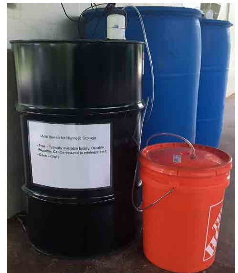
Figura 7. Dióxido de carbono de un cubo entrando a un barril metálico que contiene semilla de maíz. Se perforaron agujeros en el tubo y para facilitar el escape del aire en una tapa modificada, hecha con piezas de fontanería de PVC, para evitar perforar el barril. Fuente: Tim Motis
