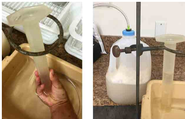
Figura 8. Método para desplazamiento del agua para medir la tasa de flujo de un gas. Fuente: Tim Motis
