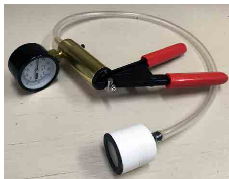
Figura 2. Bomba purgadora de frenos para vacío modificada según se explicó en ECHO TN 93. Fuente: Tim Motis
