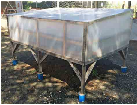
Figure 7. Boîte de séchage surélevée en Tanzanie. Source: Stacy Swartz
