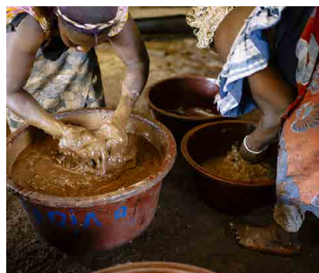
Figure 6. Rincage et séparation du beurre de karité. Source: CIFOR, licence d'attribution de Creative Commons
