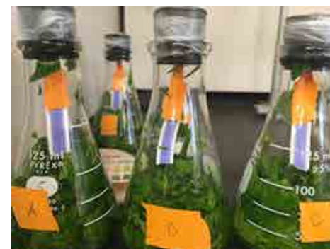
Figure 11. Les feuilles de chaya crues ont changé la couleur du papier Cyantesmo en bleu foncé, indiquant ≥ 1 ppm de cyanure. Source: Danielle Hepler
