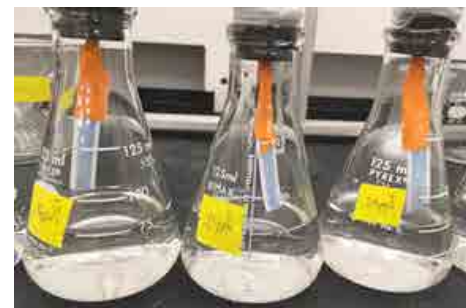
Figure 10. Couleur du papier Cyantesmo correspondant à 0,25 ppm de cyanure. Source: Danielle Hepler
