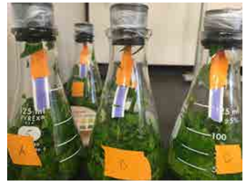
Figura 11. Hojas de chaya crudas volvieron azul oscuro el papel de Cyantesmo, indicando \geq 1 ppm de cianuro. Fuente: Danielle Hepler
