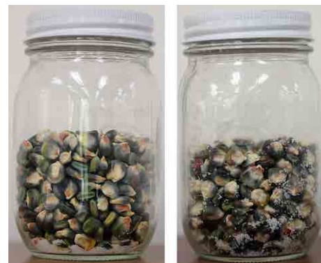
Figura 12. Frascos con sal con submuestras de semilla de maíz; la sal en el fondo del frasco indica semilla seca (izquierda) y sal pegada al frasco de vidrio indica semilla húmeda (derecha). Fuente: Tim Motis
