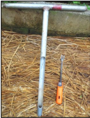
图 2 土壤取样的土壤钻（清迈的一家机械商店制造的）
