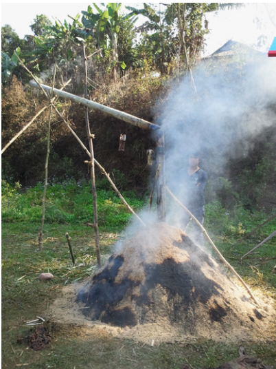
Vers la fin du processus de carbonisation (remarquez la collection de vinaigre de bois).
