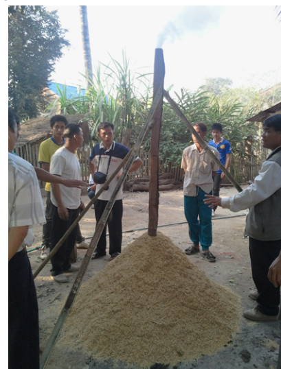
Utilisation d'un carbonisateur PhilRice de type ouvert modifié.
