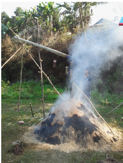
Cerca del final del proceso de carbonización (notar la colección del vinagre de madera).
