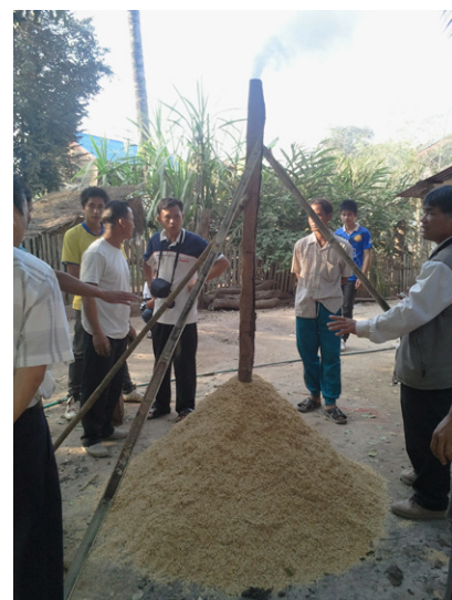
Utilizando un PhilRice Open Type Carbonizer modificado.
